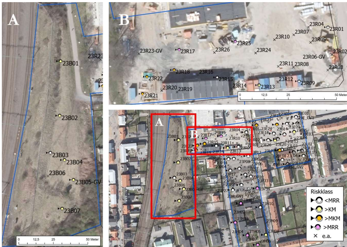
Figur 12. Översiktskarta och förstorade kartor av alla provpunkter på före detta Bangården (A) och Rangeringen inkl. riskklassning utifrån analysresultat. © Ensucan AB
