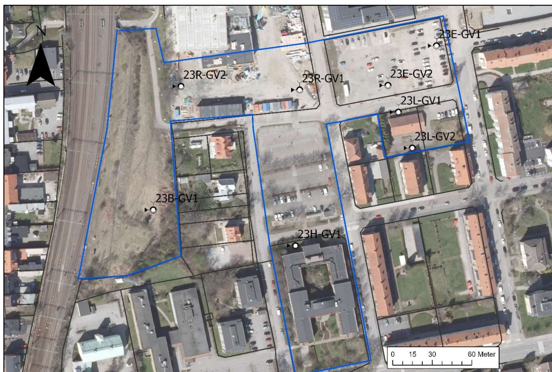
Figur 8. Lokalisering av installerade grundvattenrör inom hela undersökningsområdet. © Ensucan AB
