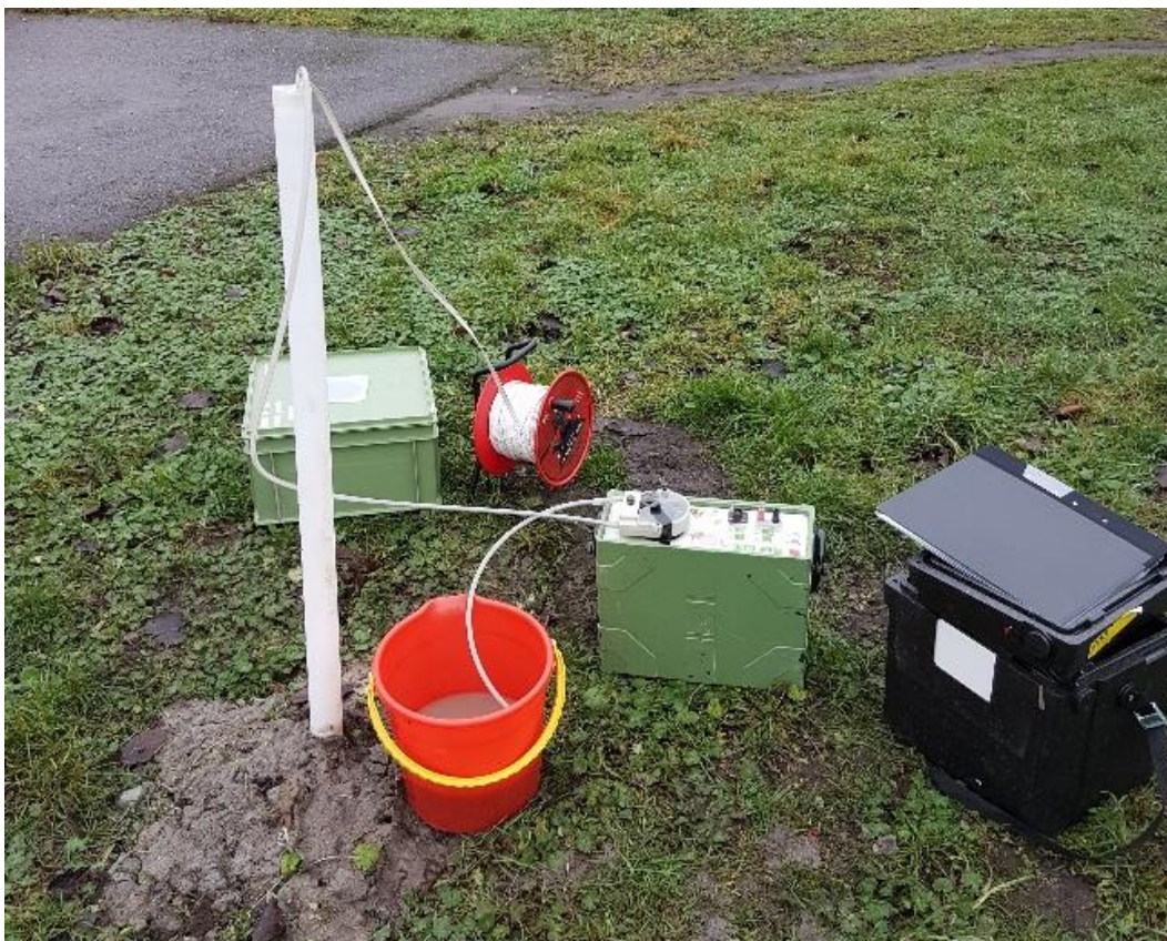
Figur 5. Grundvattenprovtagning i rör 1811.
