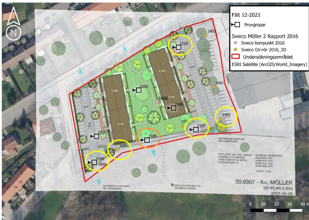
Figur 18. Provtagnings punkter som överlägger arkitekturplanen. Dels visar det gula (>KM) och orangea (>MKM) cirkel runt provtagningspunkterna det högsta påträffat föroreningen på området.
