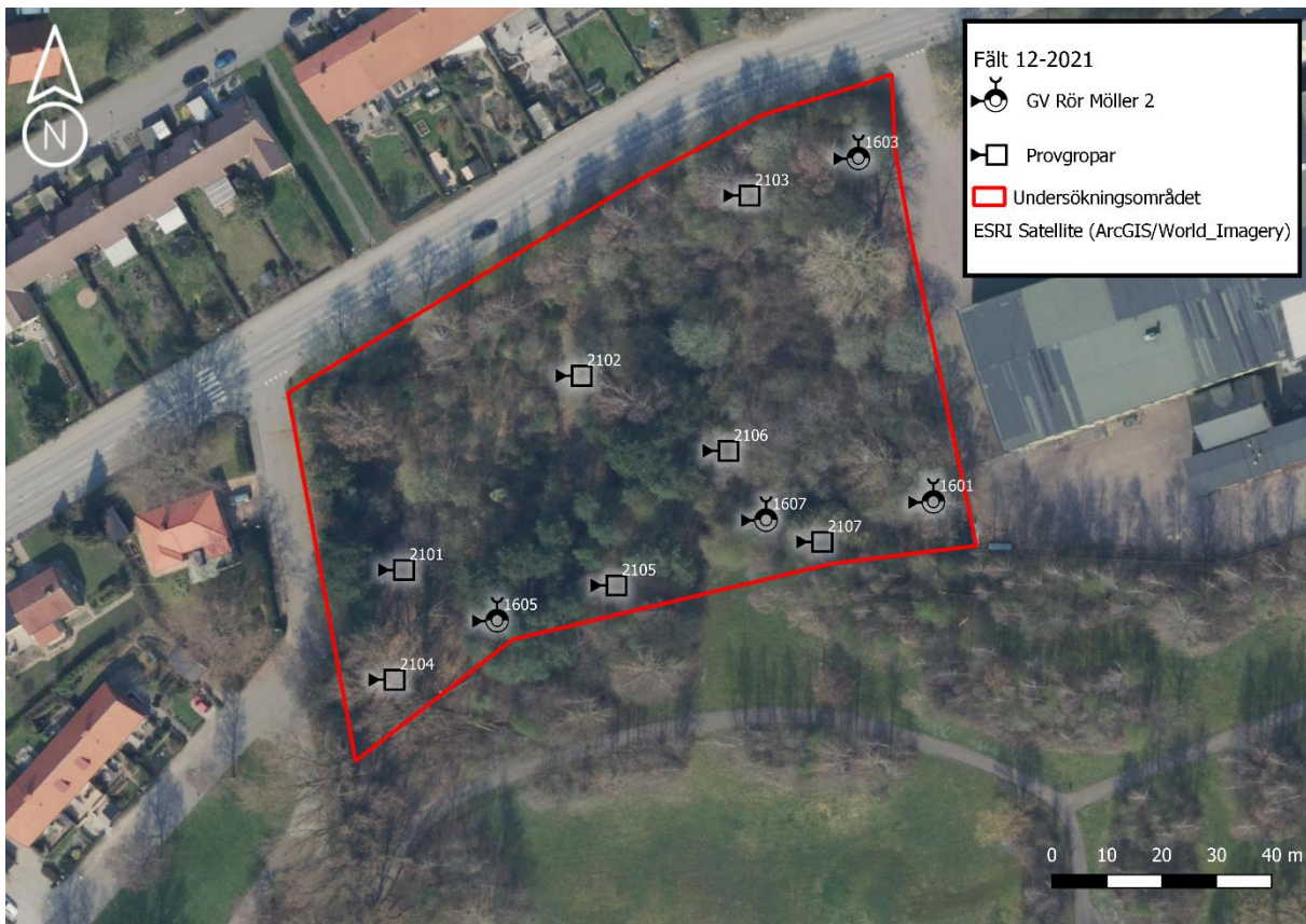
Figur 11. Kartan visar punkter som har används för jordprovtagning (provgroppar) och grundvattenrör från Sweco (2016b) som användes för grundvattenprovtagning.
