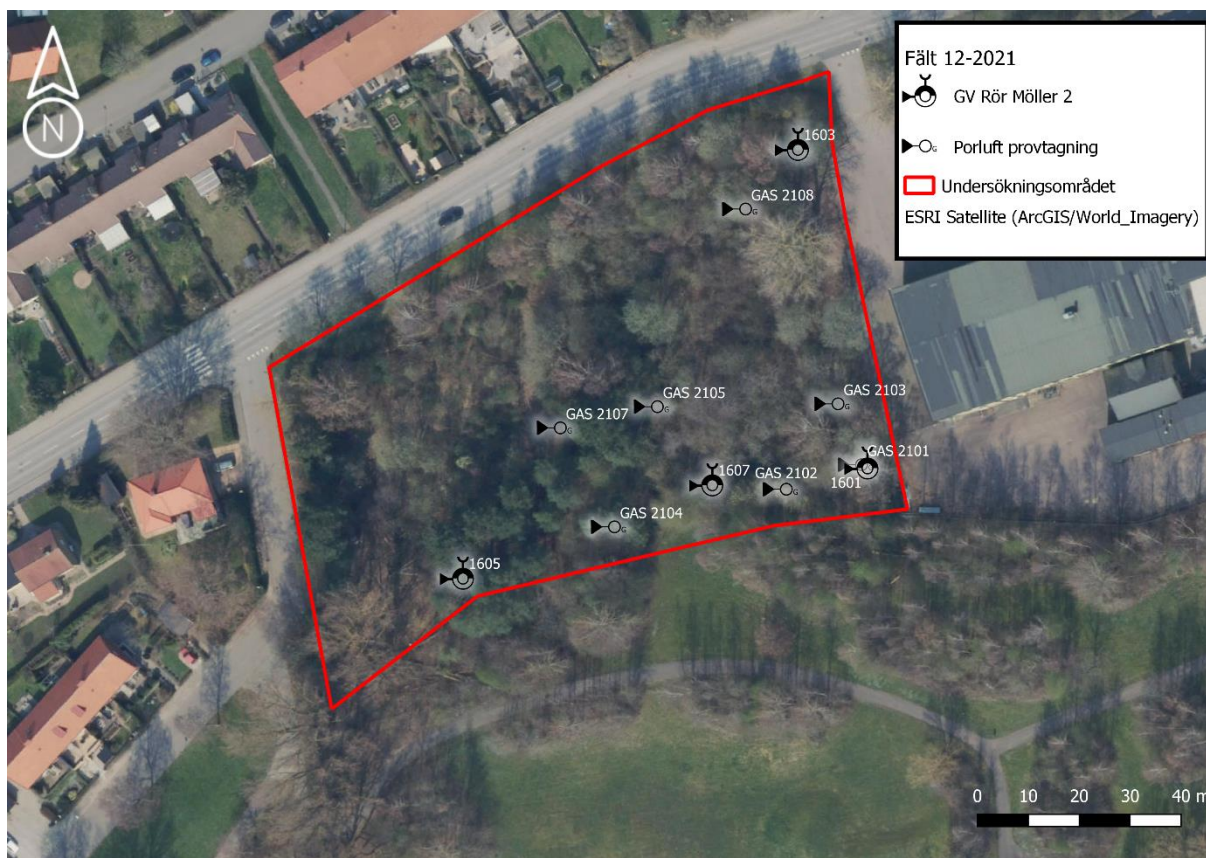
Figur 12. Karta visa punkter som har utförts luftmätningar på fastighets Möller 2. Tidigare installerad grundvattenrör från Sweco (2016b) användes för luftmätningar.
