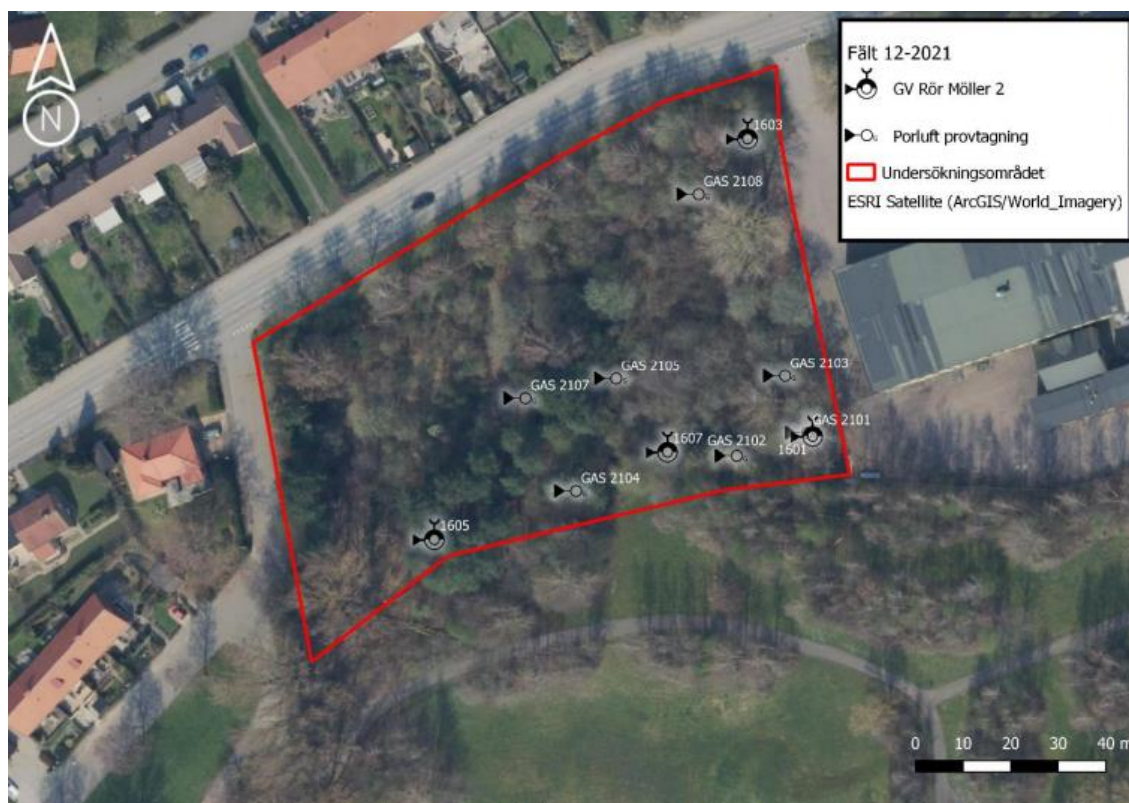
Figur 5. Kartan visar de punkter där ENSUCON AB har utfört luftmätningar (porgas).
