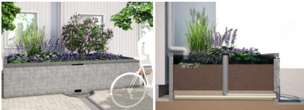
Figur 25. Exempel på upphöjd växtbädd som tar emot dagvatten från tak via stuprör (Vinnova, 2014).
