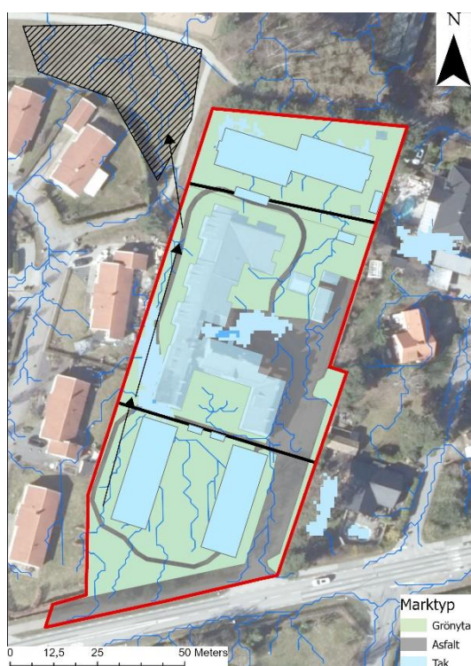
Figur 10: Utformning och placering av dagvattenlösning utanför planområdet på allmän platsmark. Placering i det svart streckade området.
