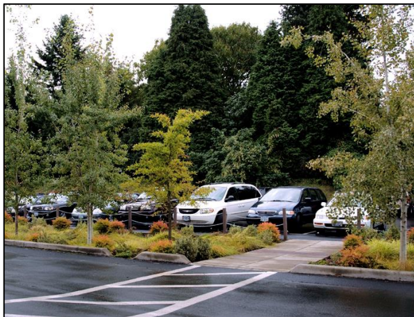
Figur 18. Parkeringsplats med avledning till växtbädd. (Bild:Stockholm stad)
