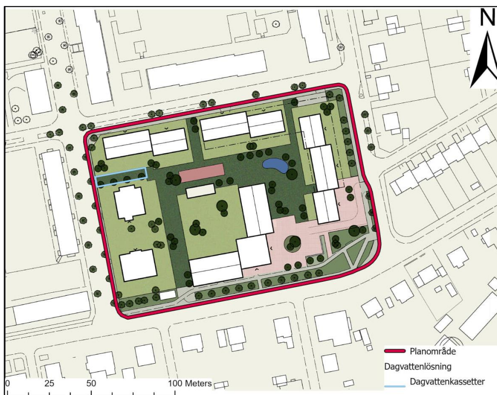
Figur 16. Illustration på placering av dagvattenlösning alternativ 2b, kassetter i två lager.
