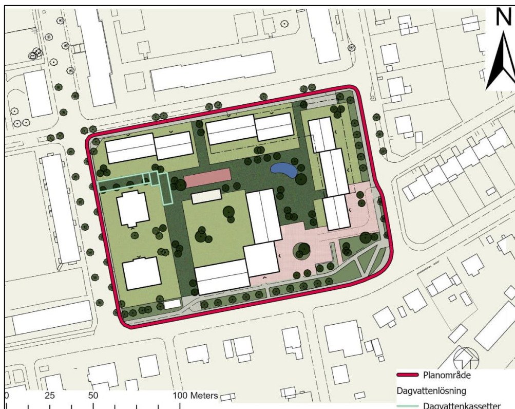
Figur 15. Illustration på placering av dagvattenlösning alternativ 2a, kassetter i ett lager.
