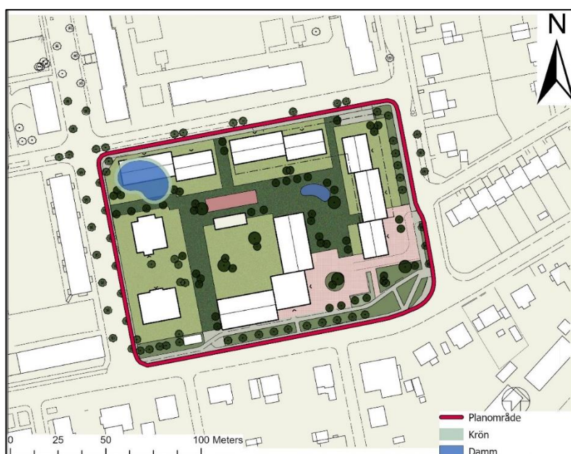
Figur 12. Illustration på placering av dagvattenlösning alternativ 1, torrdamm.
